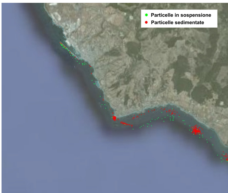
Figura 5.7.2-2 : Dispersione del sedimento proveniente dal dragaggio portuale in condizioni di Maestrale (L'immagine descrive la situazione dopo quattro giorni dal rilascio del sedimento)
