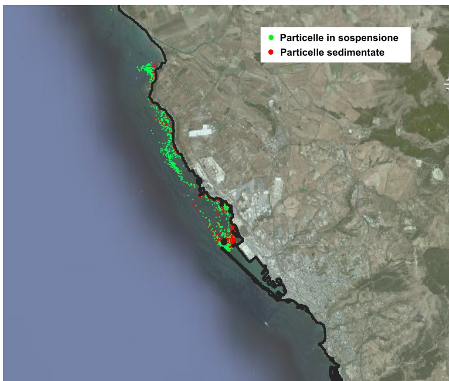
Figura 5.7.2-3 : Dispersione del sedimento proveniente dal dragaggio portuale in una tipica settimana estiva (L'immagine descrive la situazione dopo quattro giorni dal rilascio del sedimento)
